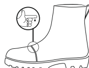
(6) Daño del forro; bordes afilados
