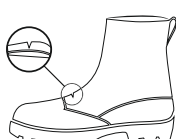
(1) Hlboké trhliny na vrchnej časti obuvi
