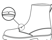
(1) Grietas profundas en la parte superior del calzado
